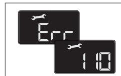
**Защитное отключение из-за низкого давления воды**
